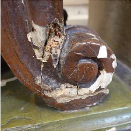
Lacunes in de verflaag en vermolming
