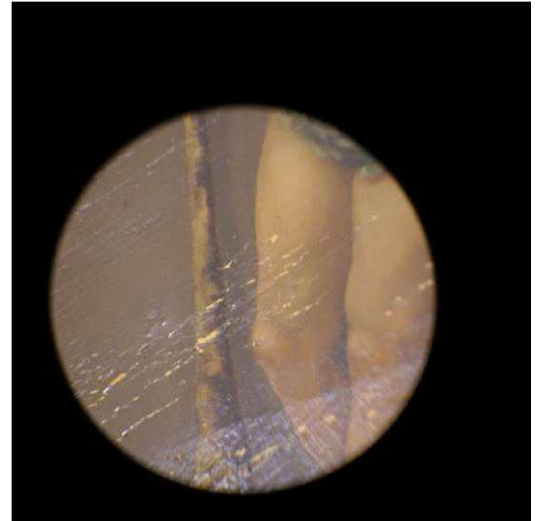
Gecraqueleerde verflaag t.h.v. spieraam (1, noordwand) Afschilferende verflaag met lacunes (2, noordwand)
